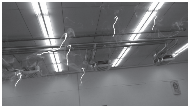
Bild 4. Strömungsdarstellung über Personen oder Personengruppen mittels Rauchfäden.
