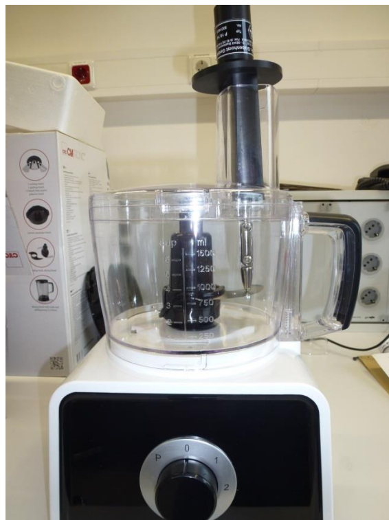
Abbildung 1: Beispiel der Berührbarkeit eines Hackmessers bei einer Küchenmaschine.
