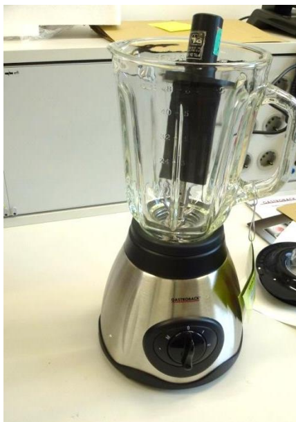
Abbildung 2: Beispiel der Berührbarkeit der rotierenden Messer eines Mixers mit GS-Zeichen
