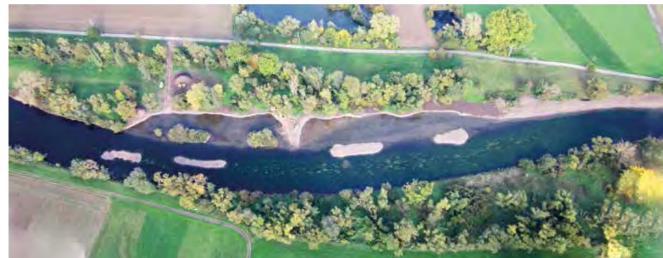
Die linke Luftaufnahme entstand vor Beginn der Renaturierungsarbeiten und zeigt einen Ederabschnitt bei Anraff, der für die Verbesserung des ökologischen Zustands und den Hochwasserschutz sehr geeignet erschien. Rechts die Aufnahme desselben Abschnitts kurz vor Abschluss der Arbeiten. Der Fluss wurde aufgeweitet, indem Bagger das Erdreich am Ufer aushoben und dort einbauten, wo die hellen Kiesinseln angelegt wurden. Fotos (2): Dr. Gerd Meitzel/Bearb.: Ina Kempf
