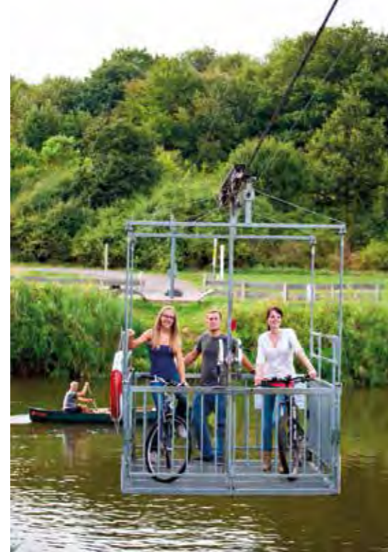
Seilbahn mit Körpereinsatz: Deutschlands erste Seilbahn für Fahrräder wird per Handkurbel über die 40 Meter lange Strecke über die Fulda bewegt. Foto: Erlebnisregion Mittleres FuldaTal
