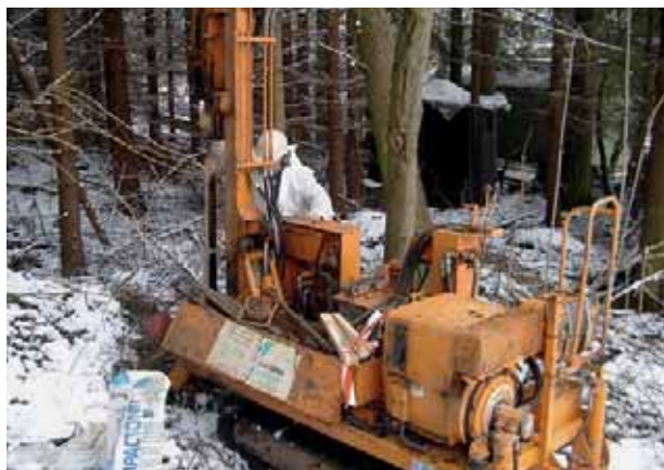
Abb. 2.3: Bohrgerät zur Durchführung von Rammkernsondierungen
