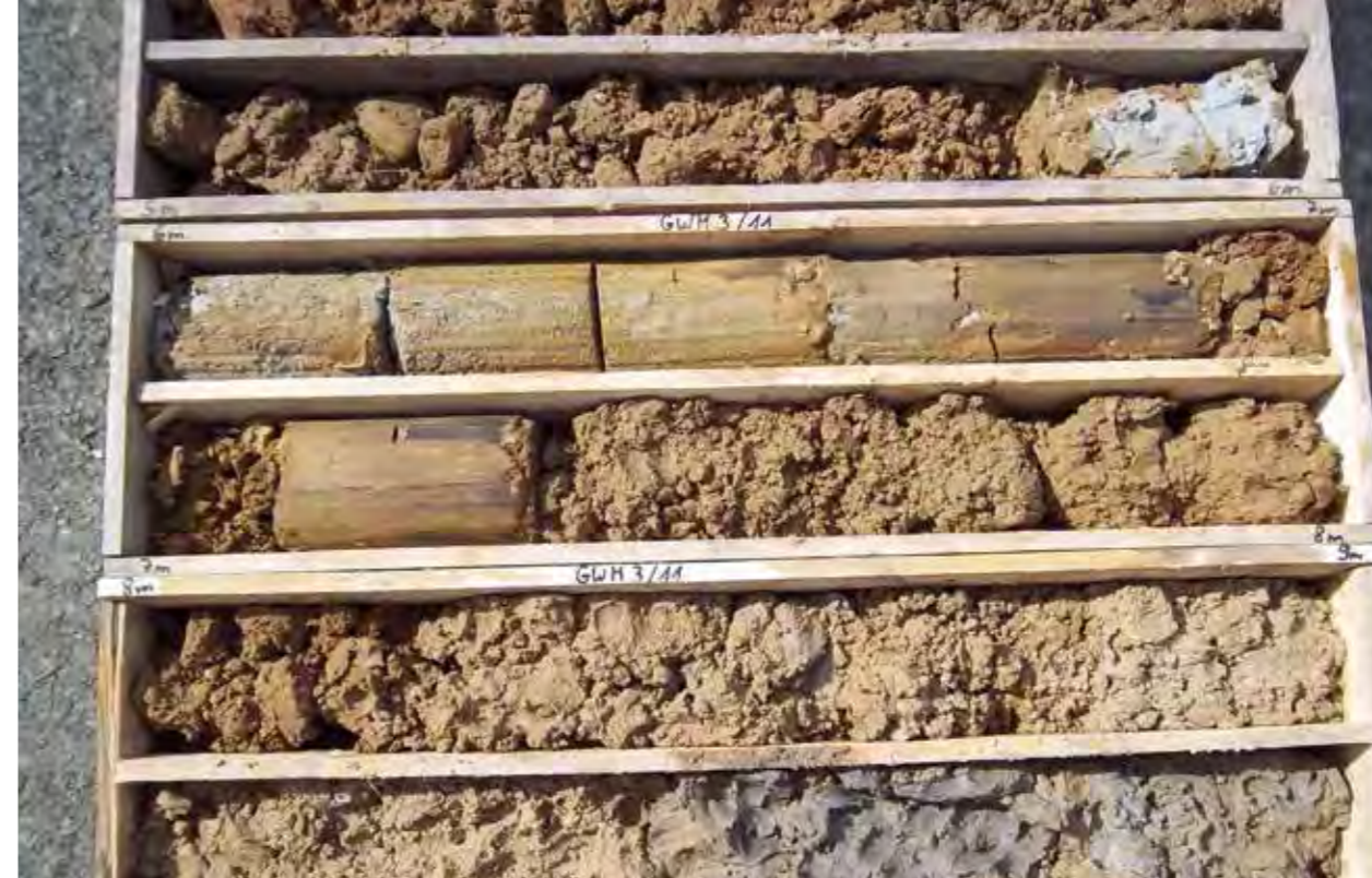
Aus einer Tiefe von fünf bis zehn Metern stammen diese Bohrkerns. Sie geben Aufschluss über den Grad der Bodenbelastung um die Grundwassermessstelle. Foto: Hund/RP Kassel
