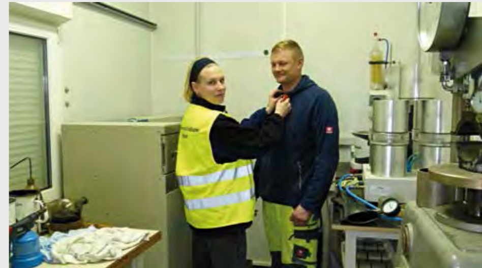
Im Rahmen einer Arbeitsplatzmessung wurde die Trichlorethen-Belastung im Qualitätssicherungslabor einer hessischen Asphaltmischanlage untersucht. Um die Belastung des Asphaltlaboranten Viktor Müller mit dem krebserzeugenden Lösemittel zu bestimmen, befestigt Carolina Hamers-Allin vom Fachzentrum für Produktsicherheit und Gefahrstoffe im Rahmen einer Arbeitsplatzmessung ein Probenahmeröhrchen im Atembereich des Beschäftigten. Foto: RP
