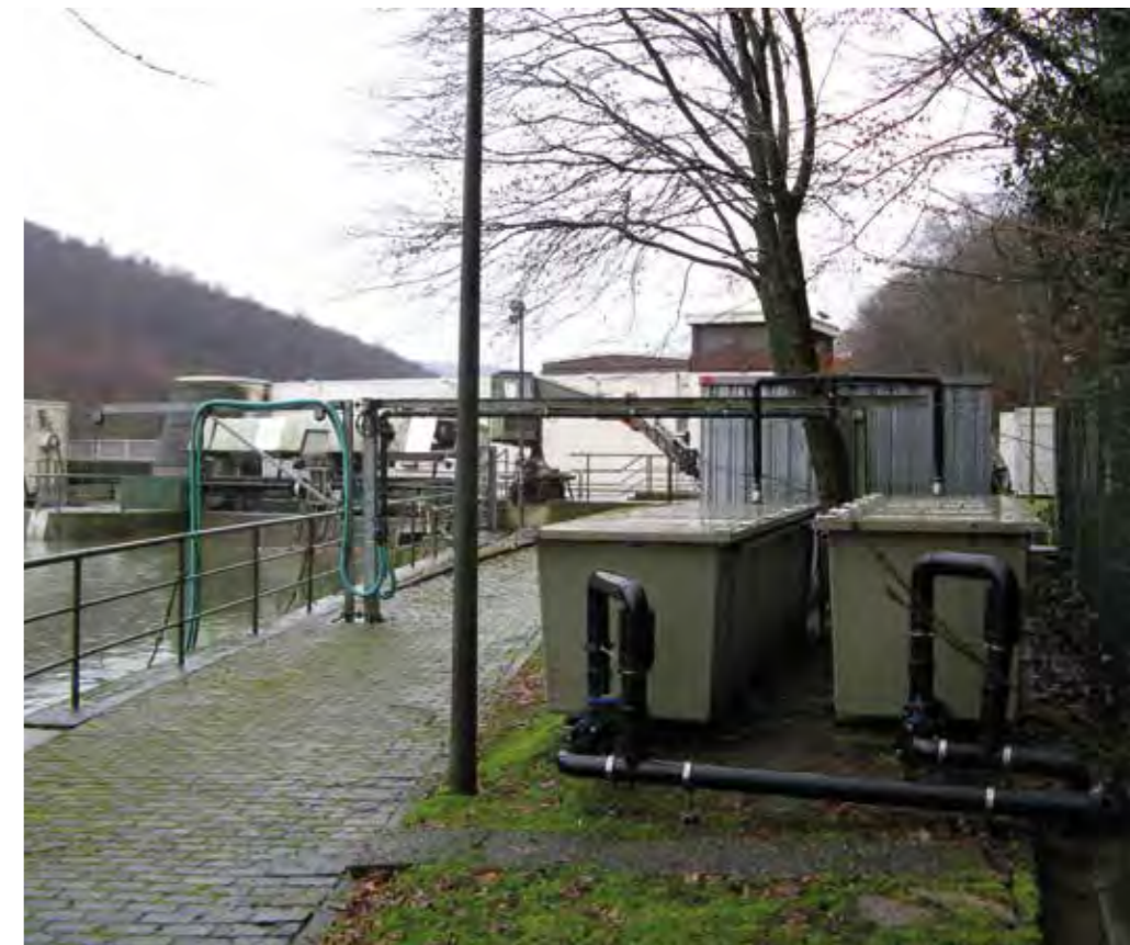
In diesen vom Flusswasser durchströmten Becken an der Fulda bei Wahnhausen befinden sich die mit den Transpondern versehenen Aale. Die Transponder in ihren Rücken zeigen an, wann es Zeit wird, die Turbinen der Wasserkraftanlagen so weit herunterzufahren, dass die Tiere unbeschädigt passieren können. Foto: Institut für angewandte Ökologie
